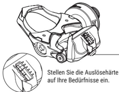
Die Auslösehärt kann mittels der Schraube (siehe Schaubild) eingestellt werden. Zum Erhöhen drehen Sie im Uhrzeigersinn, für ein leichtes Ein- und Ausklicken drehen sie gegen den Uhrzeigersinn.
